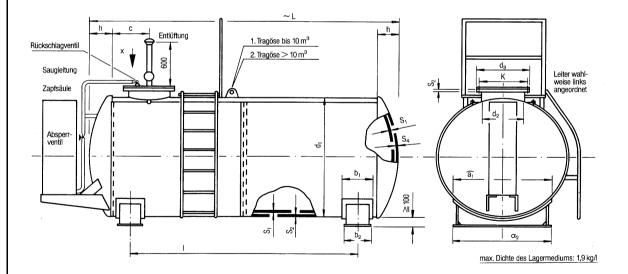
Armaturenteile ab Behälterdurchmesser 2.500 mm werden aus transporttechnischen Gründen lose mitgeliefert und müssen bauseits mit dem Behälter verschraubt werden.
